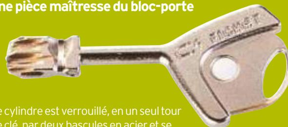
Le cylindre est verrouillé, en un seul tour de clé, par deux bascules en acier et se déverrouille grâce à ses deux aimants situés en bout de clé. Ses garnitures intérieures sont conçues pour empêcher toutes tentatives d'ouverture par crochetage. Une protection en acier traité vient renforcer sa haute résistance aux attaques par sciage, perçage et arrachement.
