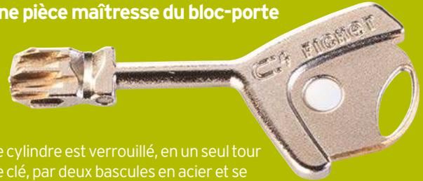
Le cylindre est verrouillé, en un seul tour de clé, par deux bascules en acier et se déverrouille grâce à ses deux aimants situés en bout de clé. Ses garnitures intérieures sont conçues pour empêcher toutes tentatives d'ouverture par crochetage. Une protection en acier traité vient renforcer sa haute résistance aux attaques par sciage, perçage et arrachement.
